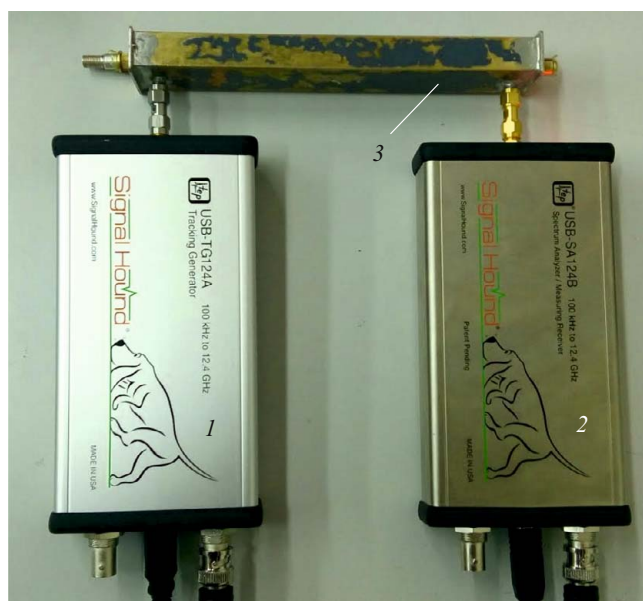
Рис. 2. Установка для измерения зависимости диэлектрических показателей масла от концентрации сажи: 1 — генератор USB-TG124A; 2 — анализатор USB-SA124B; 3 — волновод
