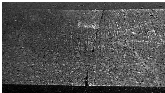
Рис. 3. Фотография дефекта в виде поперечной трещины
