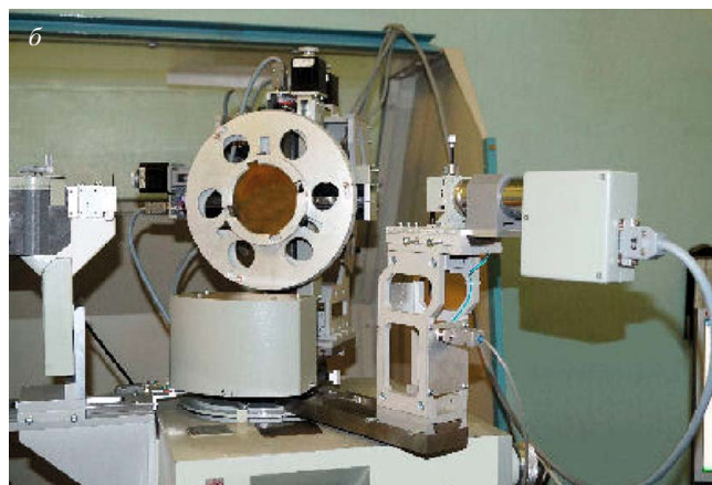
Рис. 4. Рентгенооптическая схема (а) и внешний вид (б) приставки ПДП к дифрактометру ДРОН-3
