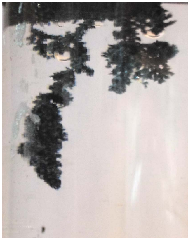
Рис. 1. Дендриты, вырастающие на катоде в процессе длительного наводороживания
