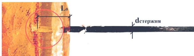
Рис. 2. Смещение стержня в месте заделки после нагружения образца: L_0 — начальная длина стержня в захватной части
