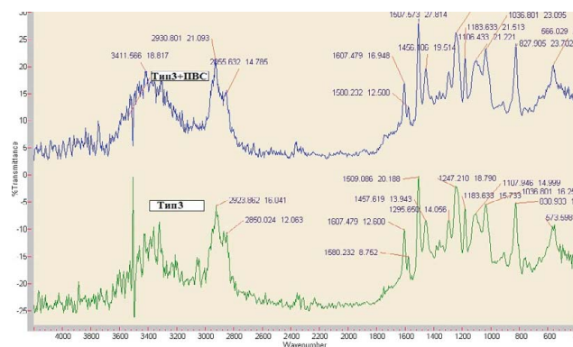
Рис. 6. Эталонный спектр связующего (тип 3) и спектр композиции в присутствии ПВС
