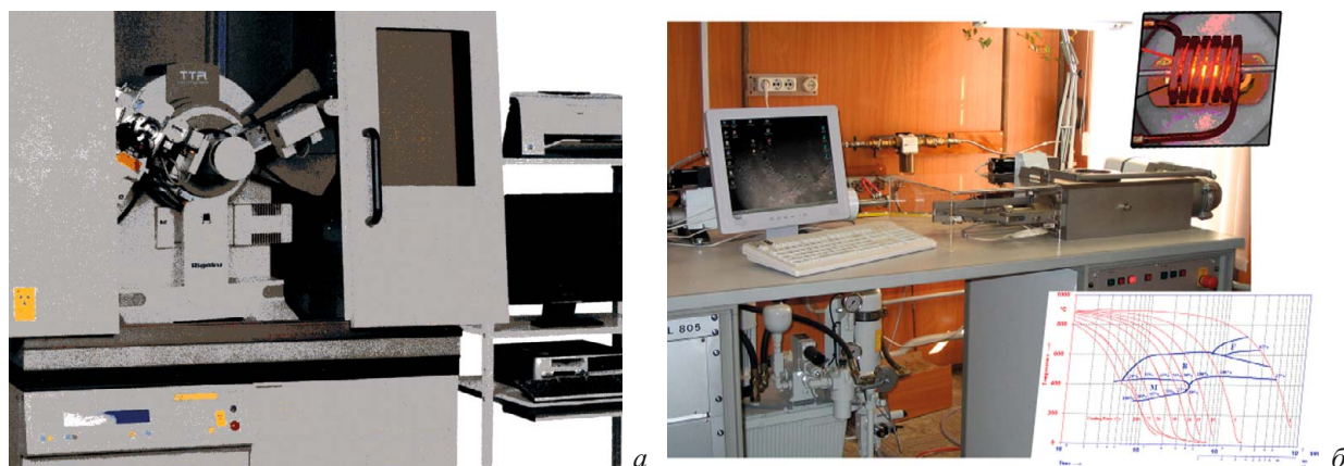
Рис. 4. Рентгеновский дифрактометр Ultima IV (а) и деформационный dilatометр DIL 805 (б). На вставках показаны индукционный нагреватель и термокинетическая диаграмма (б)
