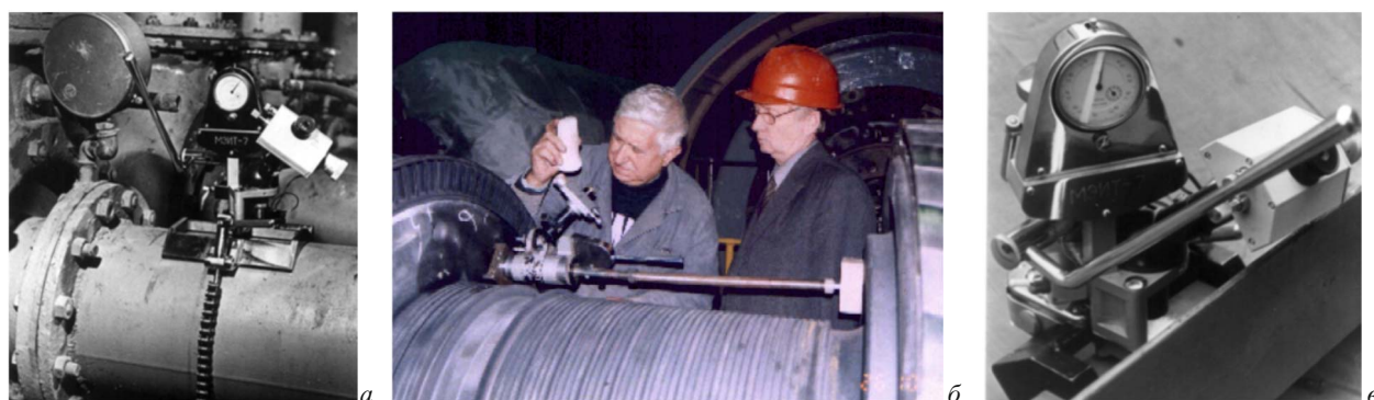
Рис. 2. Прибор МЭИ-T7 при контроле металла трубопровода (а), ротора турбины (б) и металлоконструкции (в)
