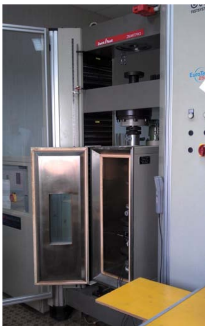
Рис. 3. Испытательная машина UTS 250 с температурной камерой
