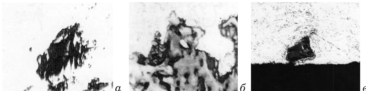
Рис. 2. Виды коррозионных повреждений вблизи неметаллических включений (Fe, Mn)S (а), MnO · Al 2 O 3 (б), MnO · SiO 2 (в) после испытаний колесной стали на малоцикловую усталость в 5 %-ном водном растворе NaCl (б) и 1 %-ном водном растворе H 2 SO 4 (а, в), \times 600
