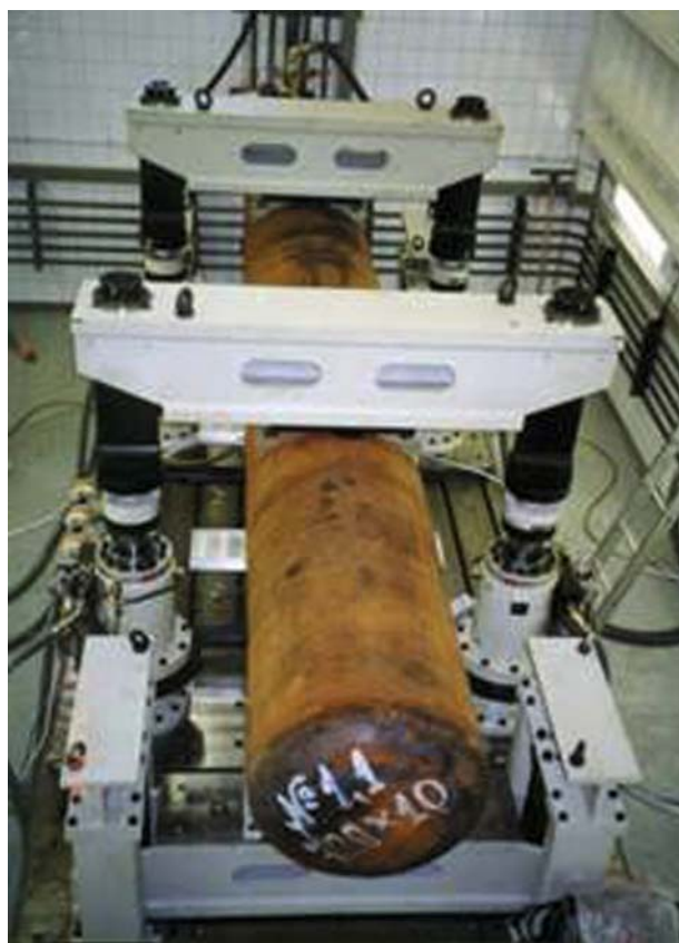
Рис. 11. Стеновые испытания труб
