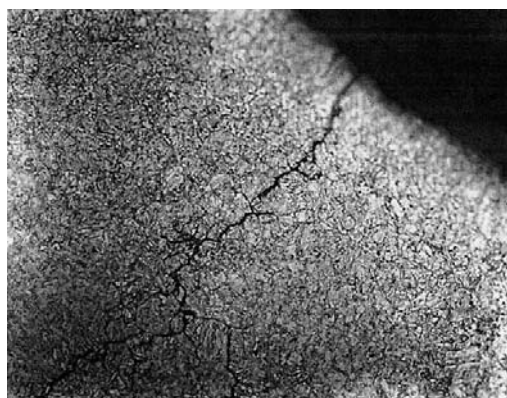
Рис. 7. Микроструктура гайки из стали 30XGSA, \times 200
