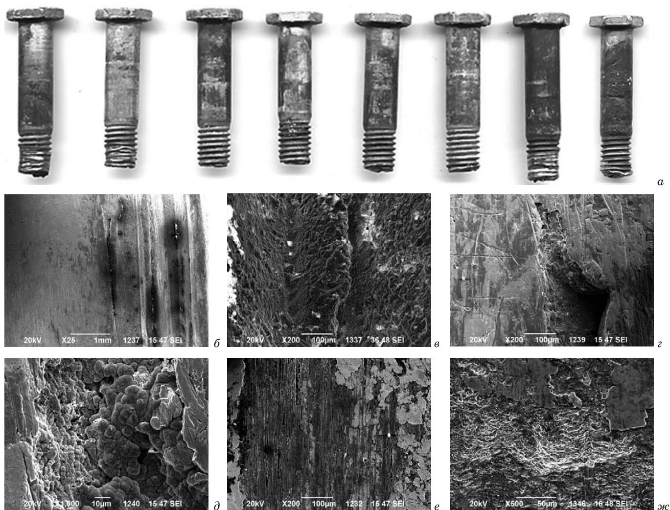
Рис. 4. Общий вид (а) и характерные повреждения (б – ж) поверхности болтов: б, в — трещина у резьбы; г, д — продукты коррозии в трещине; е — притертость; ж — растрав
