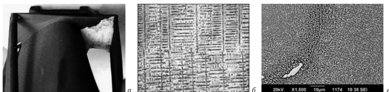
Рис. 2. Структура малоугловой («размытой») границы субзерен ( \Delta\alpha_{(001)} = 2,7^\circ ) на полке отливки лопатки из жаропрочного сплава ВЖМ4 после макротравления ( a ) ( б и в — при \times 20 и \times 1500 )
