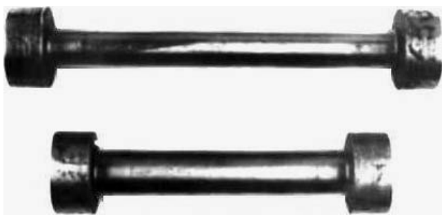
Рис. 4. Фотография недеформированного и сжатого длинномерного образцов
