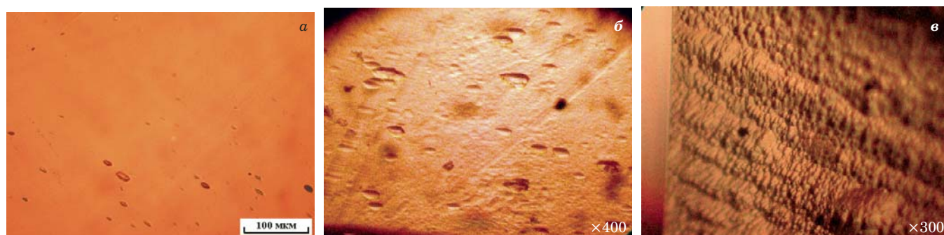
Рис. 4. Микроструктура монокристаллов ЛПТ в исходном состоянии (а), после термоудара ( \Delta T = 100^\circ \text{C} ) (б) и приложения циклических нагрузок (в)
