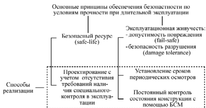
Рис. 1. Схема основных принципов обеспечения безопасной эксплуатации по условиям прочности
