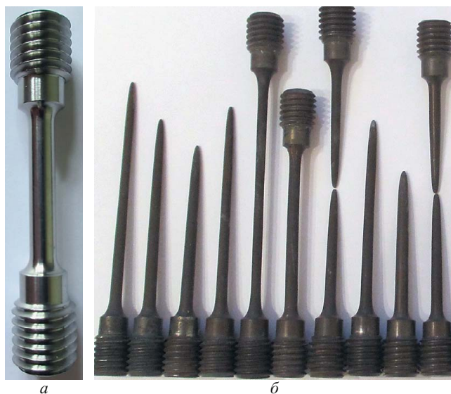
Рис. 1. Вид недеформированного (а) и испытанных (б) цилиндрических образцов из титанового сплава BT6
