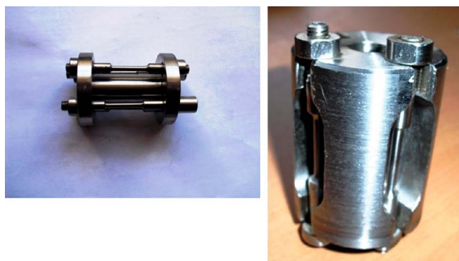
Рис. 3. Крестообразные приспособления с образцами
