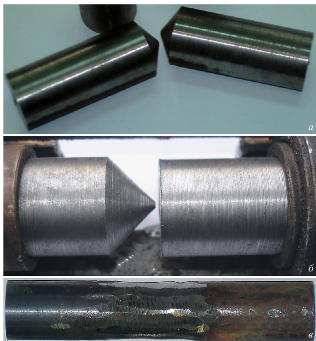
Рис. 1. Общий вид заготовок для сварного соединения с X-образной разделкой швов (а); для сварного соединения с K-образной разделкой швов — заготовки в узле специального приспособления для сварки (б); со сварным швом после выравнивания по диаметру (в)
