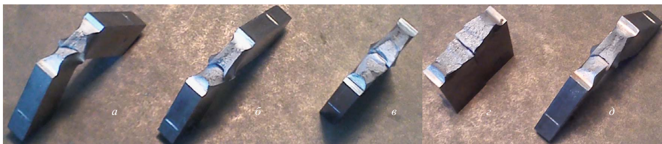
Рис. 4. Общий вид разрушенных при 233 К образцов Менаже из стали 09Г2С с надрезом: в основном металле (а); в ЗТВ (б) и на краю сварного шва (в) образцов с Х-образным сварным швом, подвергнутых закалке и РКУП; в ЗТВ после РКУП (г) и в ЗТВ после закалки и РКУП (д) образцов с К-образным сварным швом
