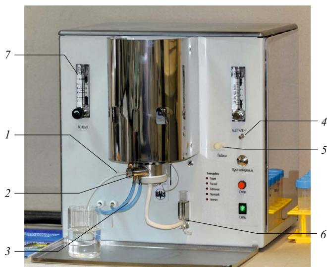
Рис. 1. Пламенный спектрометр «Павлин»: 1 — капилляр; 2 — распылитель; 3 — подвод горючего газа и окислителя; 4 — многооборотный регулятор расхода ацетилена; 5 — рычаг электро-механического поджига; 6 — гидрозатвор
