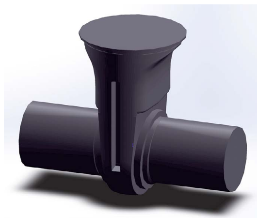
Рис. 3. 3D-модель проточной части клиновой задвижки ЗКЛ2 300-25
