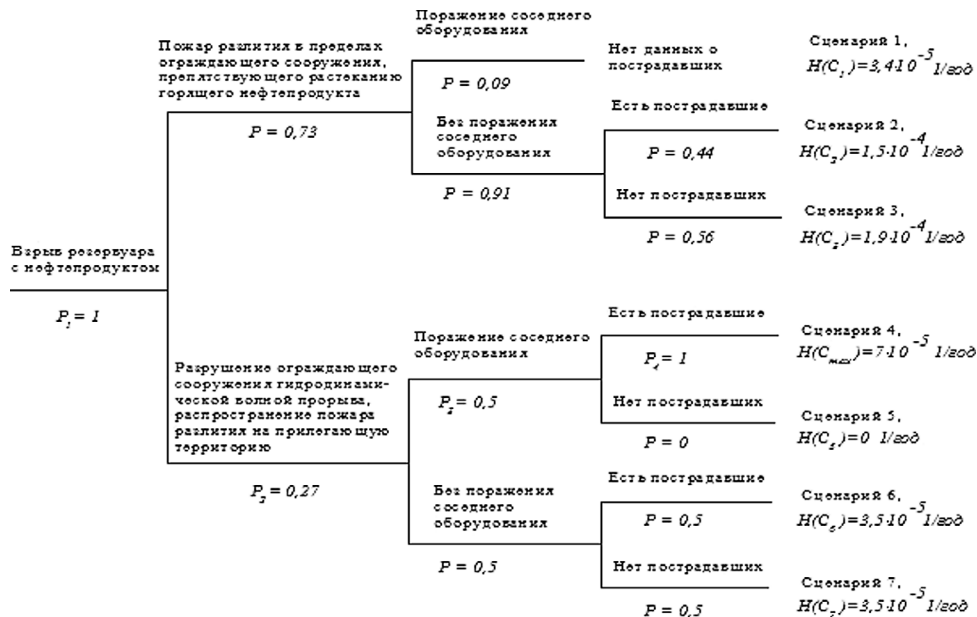
Рис. 3. «Дерево событий» при взрыве резервуара с нефтепродуктом при низких температурах эксплуатации: H(C_i) — частота реализации сценария C_i , i = 1, 2, \dots, 7
