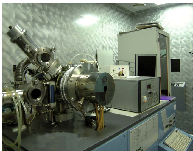
Рис. 1. Установка магнетронного напыления «Магнетон» с размещенными на ней БП МРС «БПМ-3», коммутатором магнетронов «К-2» и измерительным комплексом «ИК-1»
