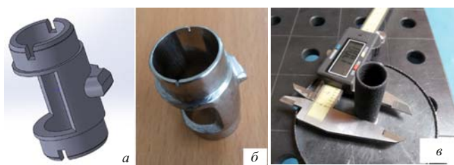
Рис. 1. Компьютерная модель (а), соединительная муфта (б), полученная методом прямого лазерного нанесения, и цилиндрическая оболочка — образец для исследования (в)
