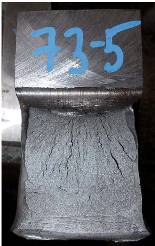
Рис. 6. Излом образца при определении T_{\text{кб}} с волокнистым участком излома у надреза и преобладающим хрупким разрушением
