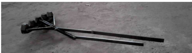
Рис. 4. Внешний вид изготовленного пробоотборника электролита
