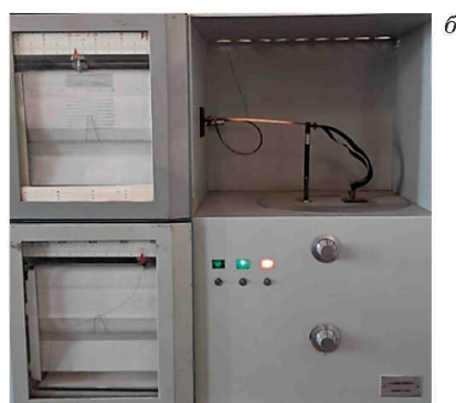
Рис. 4. Установка для исследований ползучести тензорезисторов при переменных синусоидальных нагрузках: а — кинематическая схема устройства нагружения (1 — образец; 2 — муфта; 3 — кривошип; 4 — двигатель); б — общий вид и компоновка органов управления и регистрации
