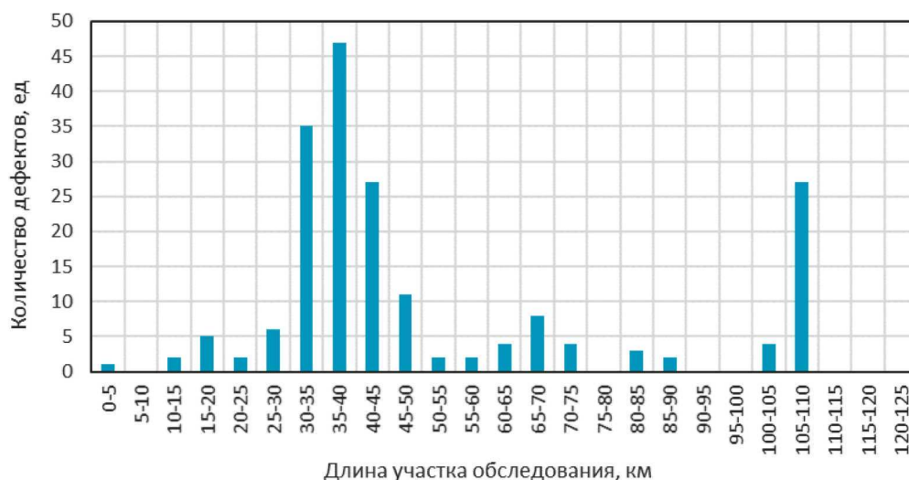
Рис. 1. Количество коррозионных дефектов по длине участка обследования газопровода Ямбург – Елец 1
