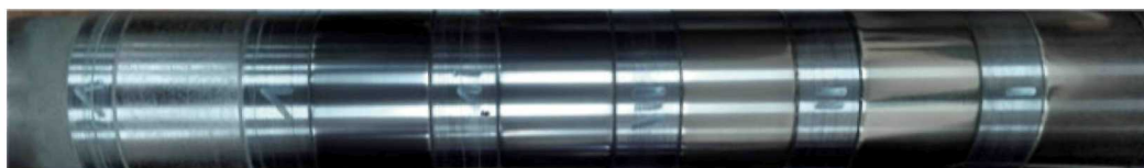
Рис. 1. Покрытия на стали 40, сформированные газопламенным напылением
