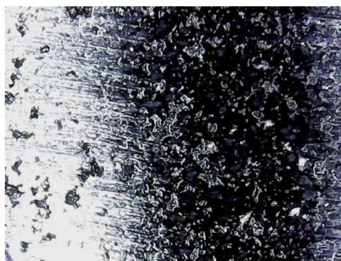
Рис. 3. Поверхность покрытий образца VI после снятия деформированного слоя
