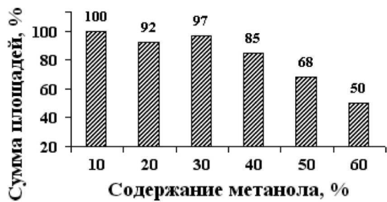
Рис. 4. Сравнение сумм площадей пиков аналитов в зависимости от содержания метанола в промывочном растворе при очистке методом ТФЭ
