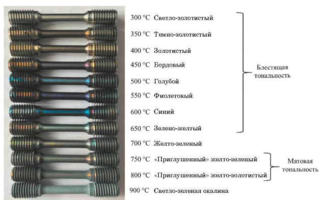
Рис. 3. Вид образцов на растяжение после окисления в воздушной атмосфере в течение 4 ч
