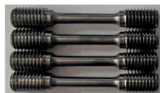
Рис. 4. Вид образцов после окисления на воздухе при 650 °C в течение 4 ч с последующим вакуумным отжигом при 750 °C в течение 2 ч
