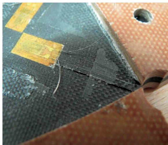
Рис. 4. Характер разрушения образца после испытаний в четырехзвеннике
