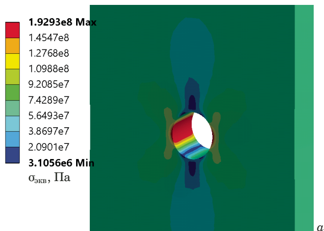
Рис. 4. Моделирование образца «полоса с отверстием» (а), результаты испытаний (б): 1 — эксперимент; 2 — аппроксимирующая кривая; 3 — кривая для модели сплава 1933; 4 — расчетные значения
