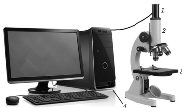
Рис. 1. Установка для исследования набухания ПГ методом оптической микрометрии: 1 — видеокамера; 2 — оптический микроскоп; 3 — источник света; 4 — ПК с необходимым программным обеспечением
