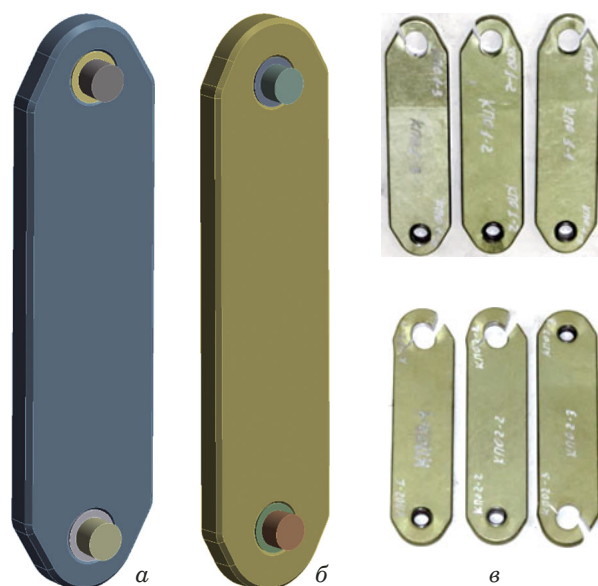
Рис. 1. Вид КПО1 (а), КПО2 (б) и разрушенных образцов (в)
