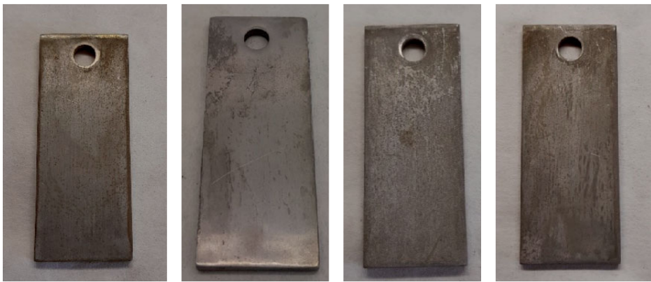
Рис. 2. Стальные образцы с коррозионными дефектами Fig. 2. Steel samples with corrosion defects
