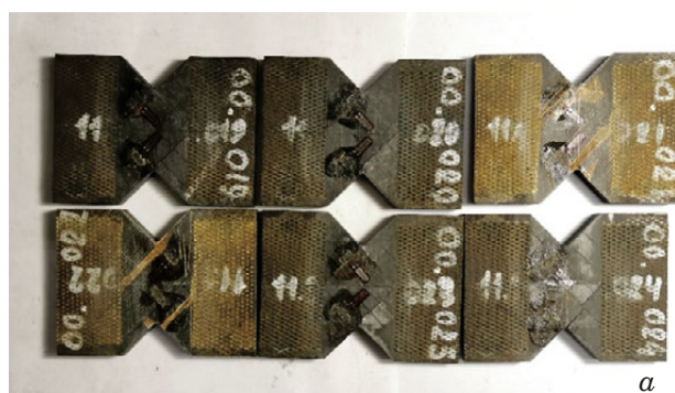
Рис. 5. Формы разрушения образцов при испытаниях по ASTM D5379 (а) и ASTM D7078 (б)
