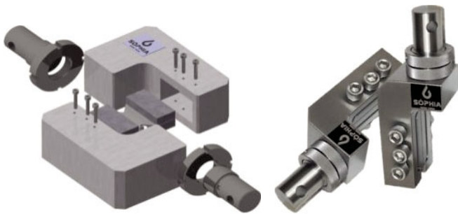
Рис. 2. Схема установки образца в оснастке по ASTM D7078 и оснастка отдельно [14]
