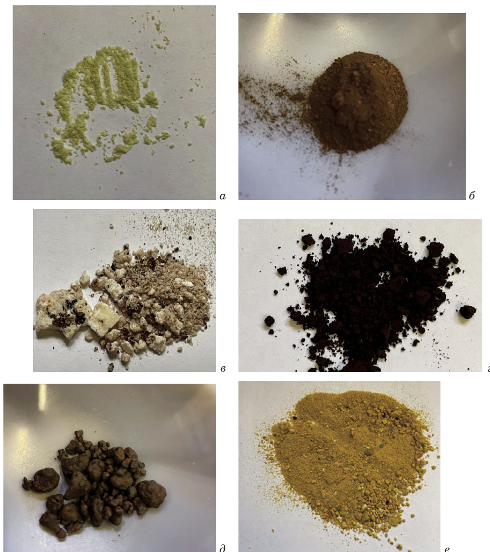
Рис. 1. Осадки 1 – 6, отобранные на лопатках дожимной компрессорной станции (а), с фильтра перед дренажной линией (б), в системе утилизации промышленных стоков (в), при приготовлении раствора ингибитора коррозии (г), изнутри (д) и снаружи (е) сквозного дефекта на водоводе соответственно
