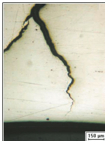
Рис. 5. Магистральная (сквозная) трещина в продольном сечении образцов (блок К ) на участке максимального напряженного состояния
