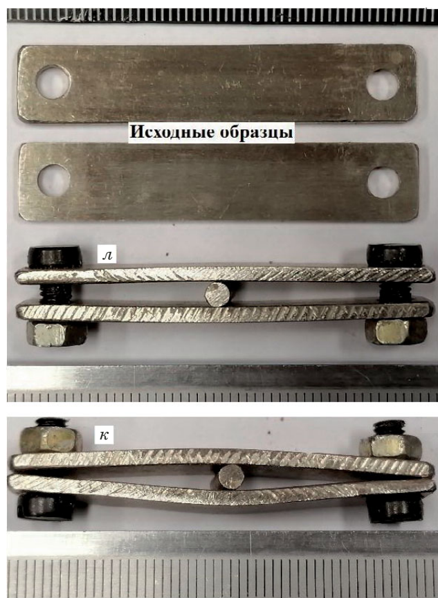
Рис. 1. Исходные образцы стали 08X18H10T и собранные блоки Л и К до коррозионных испытаний
