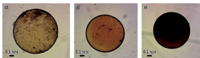
Рис. 3. Фотоизображения гранул, полученные при импрегнировании ПВС солями железа (III) и (II) с концентрациями (моль/дм 3 ): а — 0,02 и 0,01 соответственно; б — 0,05 и 0,025; в — 0,10 и 0,05
