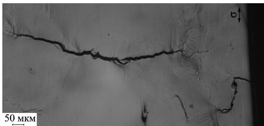
Рис. 8. Снижение раскрытия центральной трещины и увеличение раскрытия трещины, вышедшей на поверхность образца, N/N_f = 0,89
