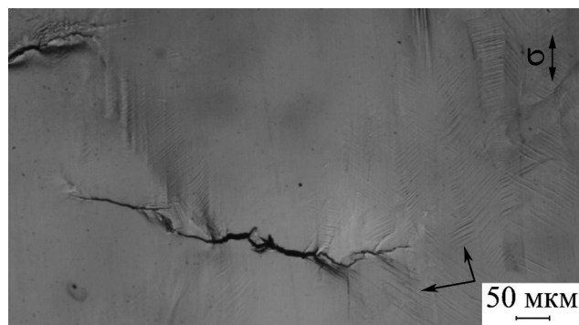
Рис. 5. Слияние и дальнейшее развитие малых трещин, формирование полос скольжения (показаны стрелками), имеющих различную ориентацию, N/N_f = 0,34
