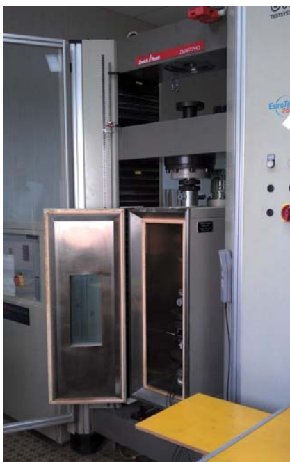
Рис. 3. Испытательная машина UTS 250 с температурной камерой
