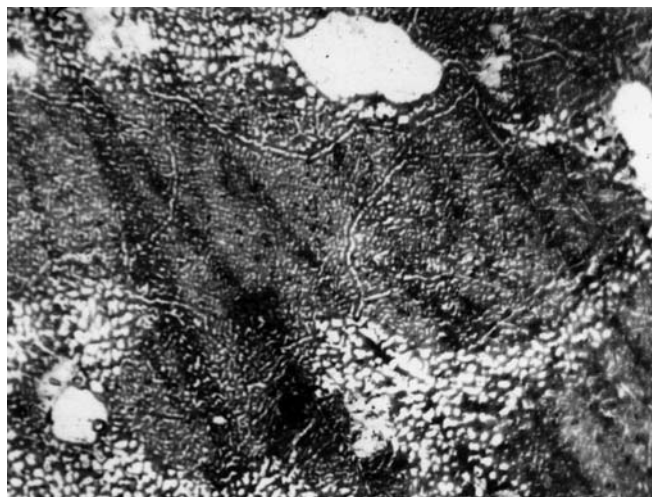
Рис. 3. Полигонизация материала в наиболее нагреваемой зоне пера рабочей лопатки из сплава ЖС6У (двигатель в последнем полете работал при температурах, превышающих максимально допустимые), \times 1000
