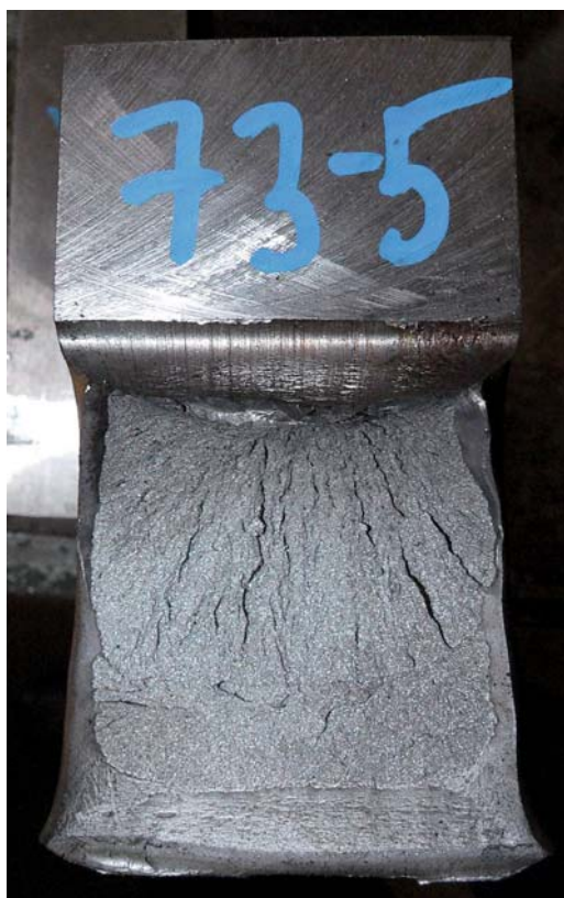
Рис. 6. Излом образца при определении T_{кб} с волокнистым участком излома у надреза и преобладающим хрупким разрушением
