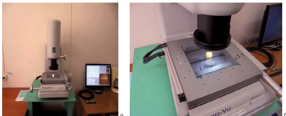
Рис. 2. Видеоизмерительная машина модели Micro-Vu Sol 161 (а) и зона ее предметного стола (б)
