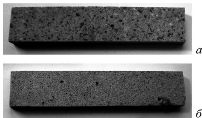
Рис. 1. Заготовки образцов заводского (а) и монтажного (б) материалов изоляции
