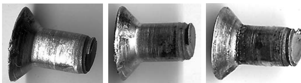
Рис. 8. Общий вид разрушенных болтов
