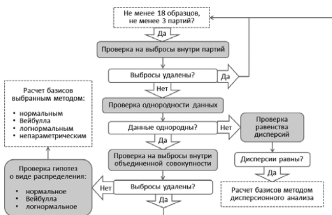
Рис. 2. Схема процедуры расчета значений базисов (требования к количеству образцов указаны для определения В-базиса)
