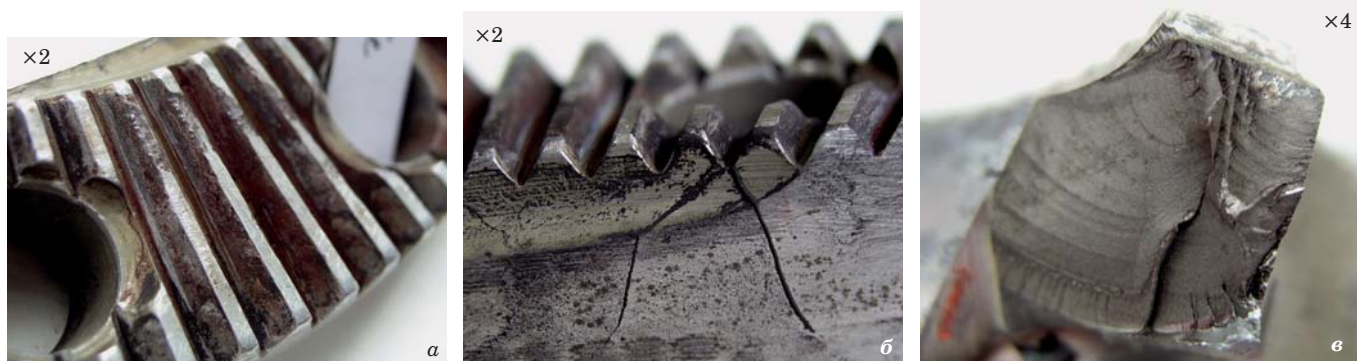
Рис. 2. Усталостное разрушение фланца вала № 3: а — фреттинг-коррозионное повреждение шлицев; б — усталостная трещина по межшлицевой впадине со стороны малого модуля с выходом на внутреннюю коническую поверхность вала; в — фрагмент вскрытой усталостной трещины
