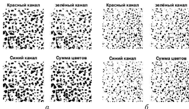
Рис. 4. Обработанные отдельные изображения по цветам и их сумма для мембран ОПМН-П (а) и ОФАМ-К (б)
