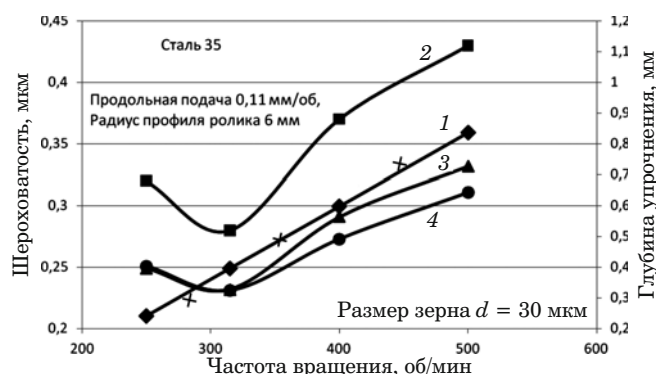
Рис. 4. Зависимость глубины упрочнения (1) и шероховатости поверхности вала (2, 3, 4) от частоты вращения центробежного обкатника: ■, ▲, ● — исходная шероховатость R_a равна 5,0; 1,25; 2,5 мкм соответственно; × — глубина упрочнения, определенная экспериментально
