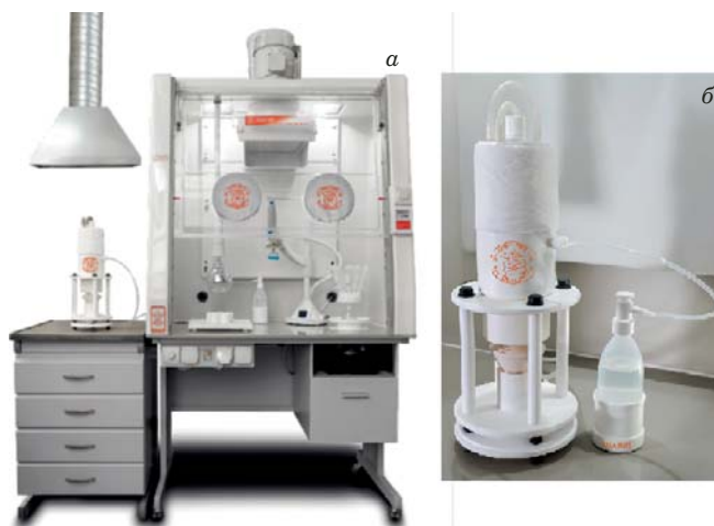
Общий вид комплекса «Чистое Рабочее Место» (а) и системы перегонки кислот (б)
