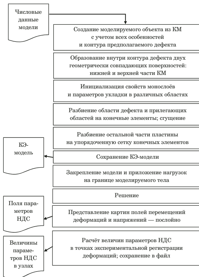
Рис. 2. Схема алгоритма моделирования и расчета НДС в зоне дефекта (типа расслоения) в КМ с использованием 2D модели
