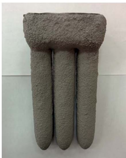
Рис. 1. Литниковая форма для выплавки заготовок СО ЖНС методом направленной кристаллизации
