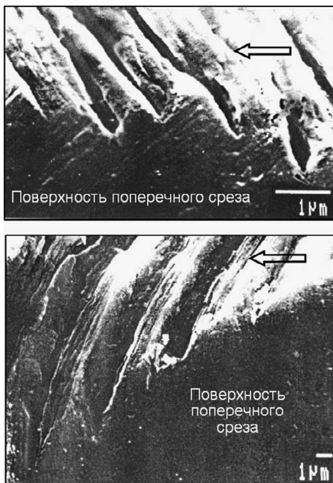
Рис. 7. Поперечные срезы усталостных бороздок [38] (стрелки — направление роста трещины)
