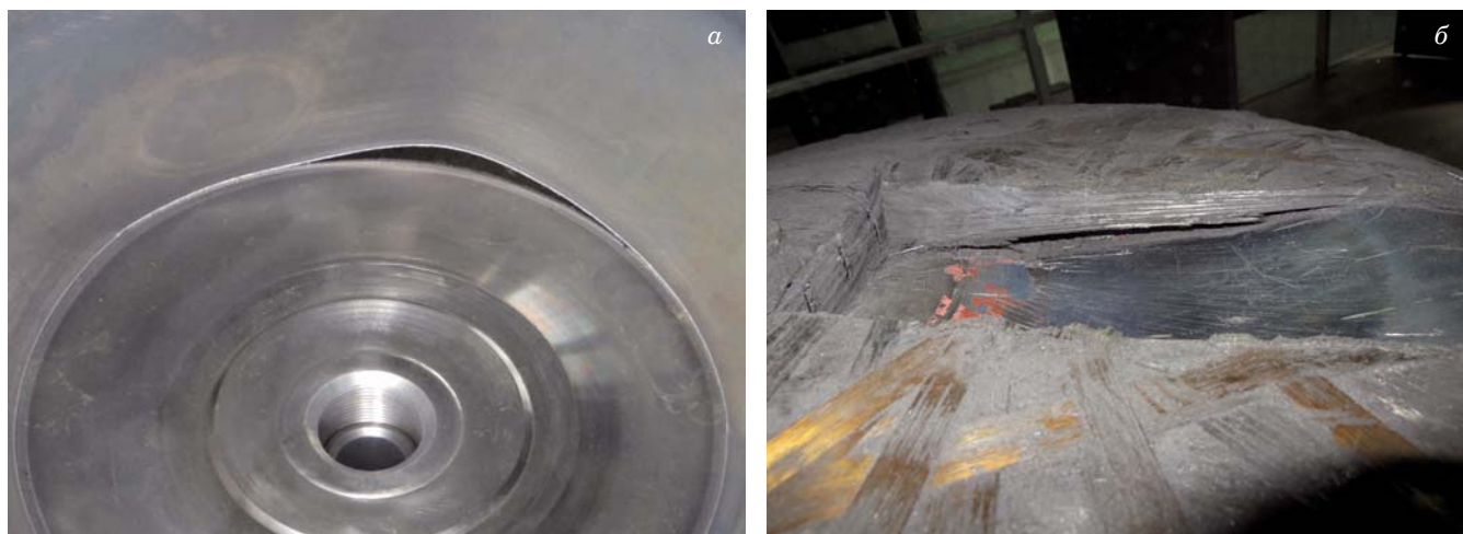
Рис. 4. Характер повреждений бака при испытаниях: а — разрушение сварного соединения; б — потеря устойчивости лайнера
