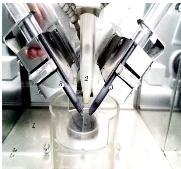
Рис. 2. Фотография устройства просыпки – вдувания, через которое в разрядный промежуток вводят водный аэрозоль: 1 — струя водного аэрозоля; 2 — кварцевая воронка, через которую в разрядный промежуток вводят порошковую пробу или аэрозоль; 3 — угольные стержни, между которыми горит дуга
