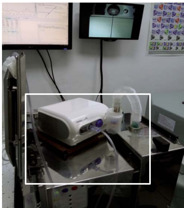
Рис. 1. Фотография компрессорного распылителя, установленного на электродуговой установке «Поток»
