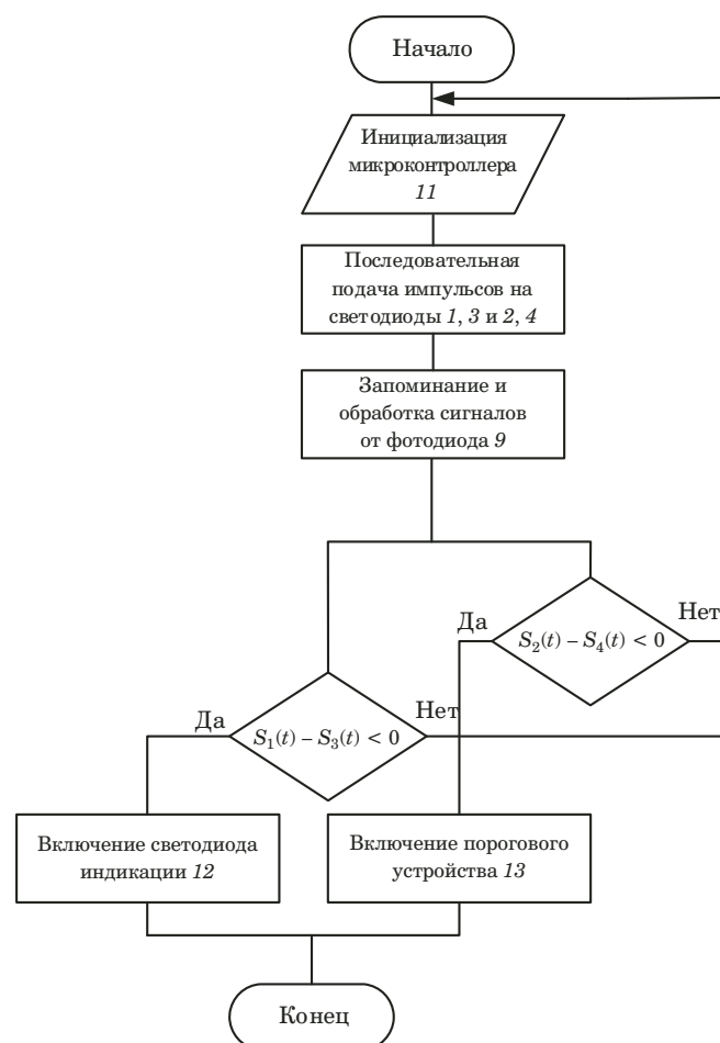
Рис. 3. Блок-схема алгоритма управляющей программы микроконтроллера
