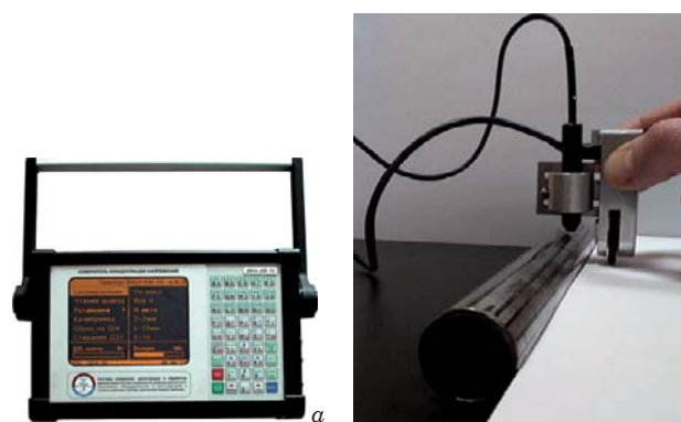
Рис. 2. Измеритель остаточных напряжений ИКН-4М-16 (а) и сканирующее устройство «Тип 15» (б)
