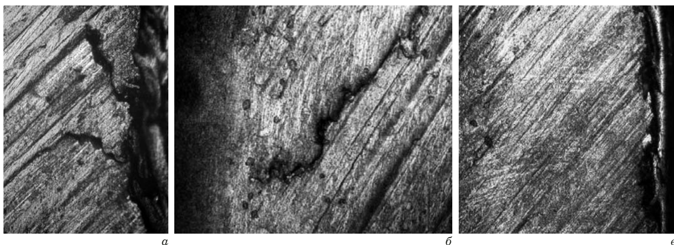
Рис. 5. Структура сечения образца внутри стенки трубы (а), в центре \text{ЗКН}_{\max} (б) и в приповерхностном слое (в) после разреза и травления ( \times 100 )
