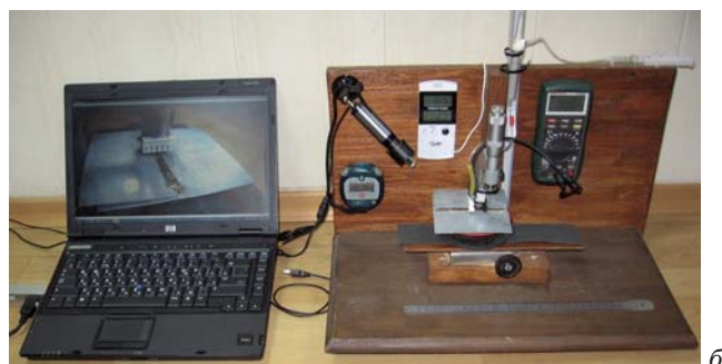
Рис. 2. Схема (a) и общий вид (b) установки для измерения электродных потенциалов
