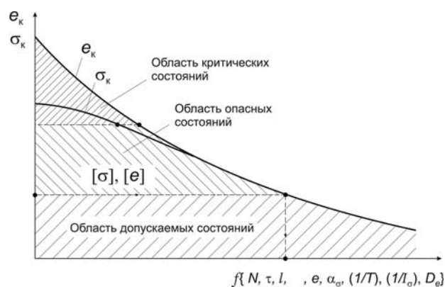
Рис. 4. Характер изменения критических напряжений \sigma_k и деформаций e_k под влиянием температурных и эксплуатационных факторов
