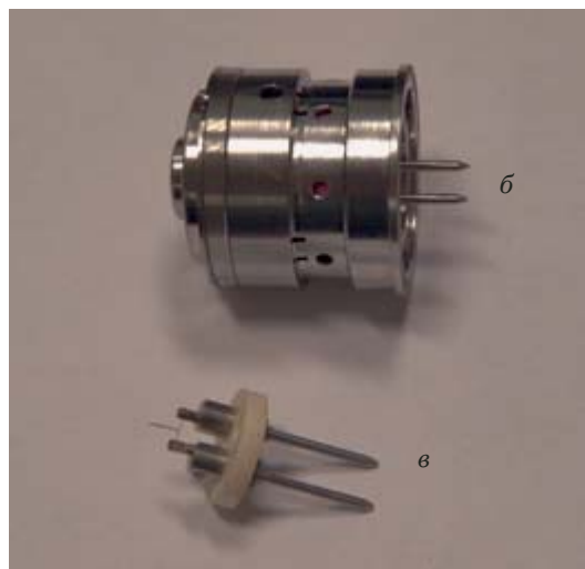
Рис. 5. Разборная рентгеновская трубка с постоянной откачкой с электромагнитной фокусирующей системой (а), катодный узел (б) и катод (в)
