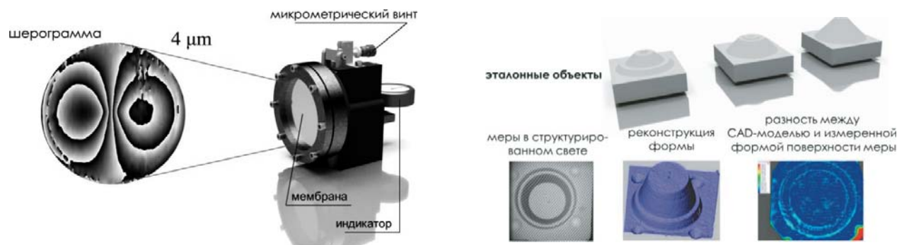
Рис. 6. Мера деформации и шерограмма (слева); меры для сканера-профилометра и результаты его калибровки (справа) Fig. 6. The loading device and the shearogram (left); cones for imitation of the surface shape and results of calibration (right)
