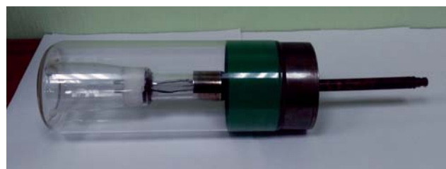
Рис. 7. Рентгеновская трубка БС-16 (III)
