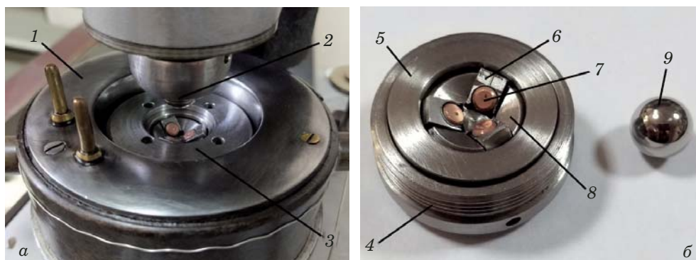
Рис. 1. Модернизированный узел трения машины КТ-2: а — общий вид; б — оправка (накидная гайка снята); 1 — масляная чаша; 2 — шпиндель машины; 3 — оправка в сборе; 4 — корпус оправки; 5 — прижимное кольцо; 6 — кулачок; 7 — исследуемый образец; 8 — сепаратор; 9 — шарик
