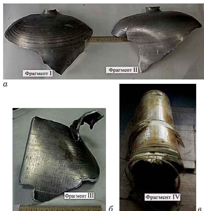
Рис. 1. Общий вид фрагментов разрушившегося лейнера: а, б — фрагменты нижней части; в — верхняя часть со стороны вентиля с сохранившейся композитной оболочкой
