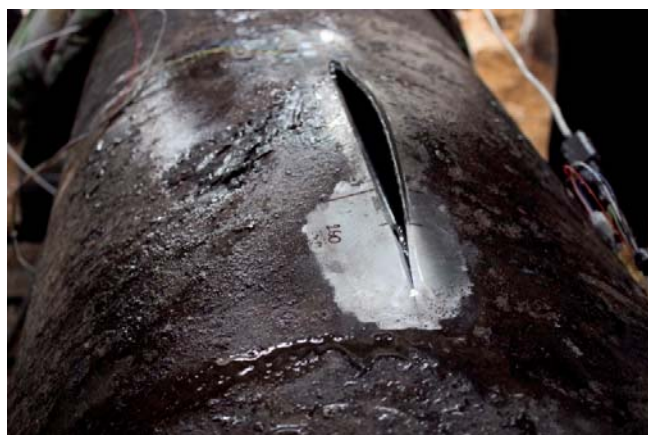
Рис. 3. Трещина, образовавшаяся при испытаниях фрагмента линейного участка трубы
